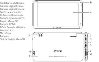
A | Pantalla Touch Screen. B | Cámara digital frontal. C | Cámara digital trasera. D | Botón de encendido. E | Orificio de Reseteado. F | Entrada de auriculares. G | Puerto MicroUSB. H | Entrada HDMI. I | DC-IN-Entrada eléctrica. J | Volumen +/- K | Micrófono. L | Parlante. M | Slot de tarjeta MicroSD.
